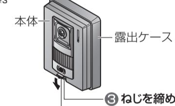
※3 電動ドライバーなどを使う場合は、ねじの破損防止のため、締め付けトルクを0.7 N·m(7 kgf·cm)以下に設定してから固定してください。
