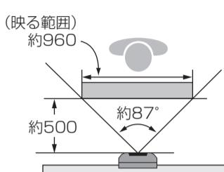
下図のように、標準位置より低い位置や、左または右に離れた位置に設置する場合には、カメラ角度調節レバーで、映る範囲を調節できます。(☞「2 ドアホンを取り付ける」の手順3)
